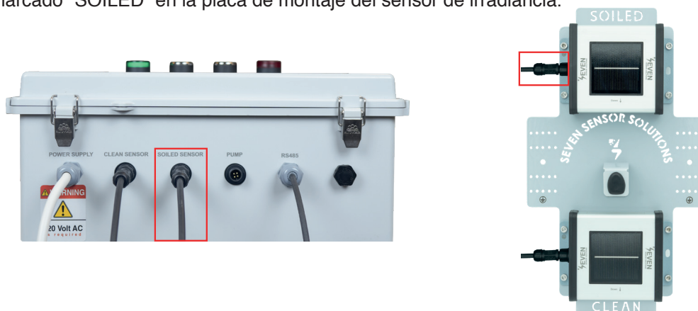
Figura 11 – Conexión del Cable del Sensor de Irradiancia Sucio
