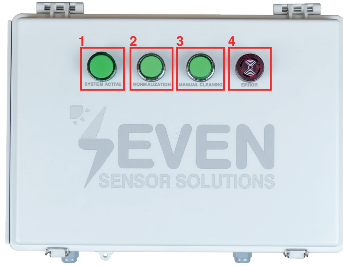
Şekil 16 – Elektronik Pano Göstergeler ve Butonlar
